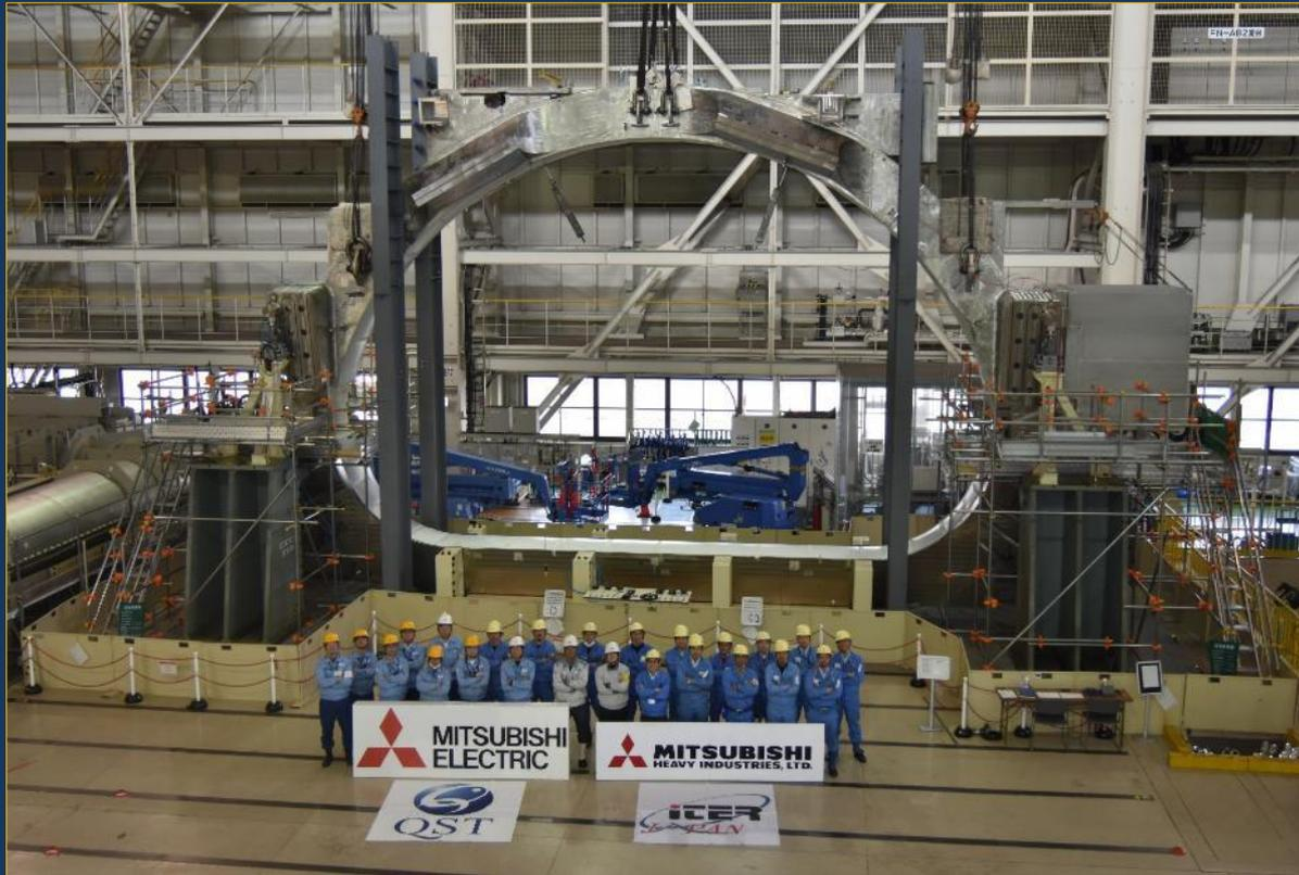
Dans les ateliers de Mitsubishi Heavy Industry, au Japon, insertion verticale du bobinage d'un aimant de champ toroidal (TF) dans son boîtier. L'ensemble pèse plus de 300 tonnes et les tolérances d'assemblage sont de 0,2 millimètres.
